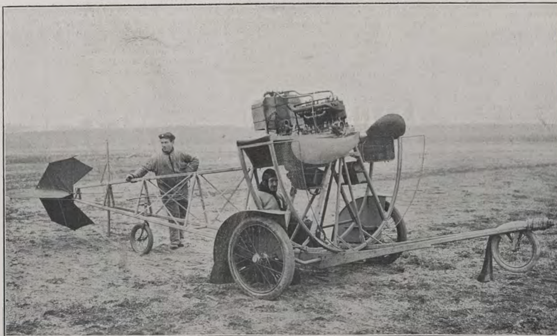
CURIEUX APPAREIL PERMETTANT D'INITIER LES DÉBUTANTS A LA CONDUITE DES MONOPLANS TYPE « DEMOISELLE » SANTOS DUMONT
